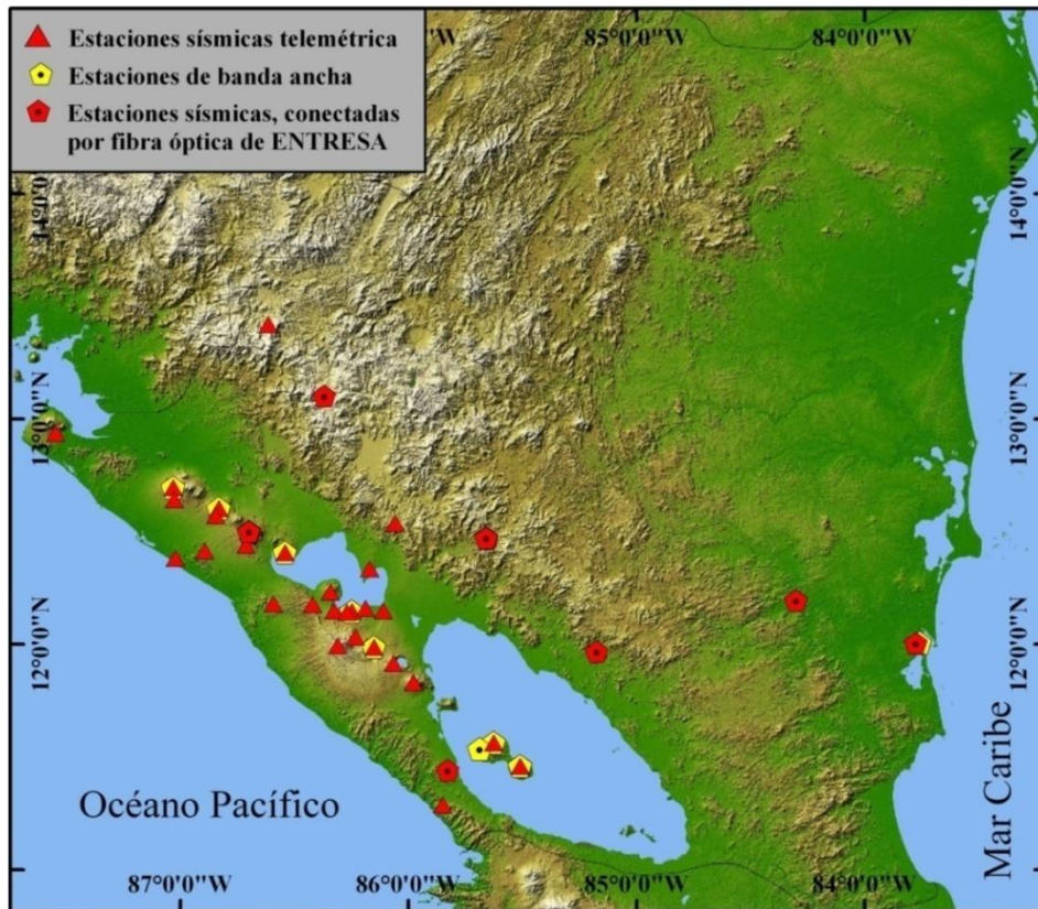
Mapa 4.3: “Red de Estaciones Sísmicas Telemétricas en que se apoya el Monitoreo y Pronóstico de INETER para Tsunamis”
